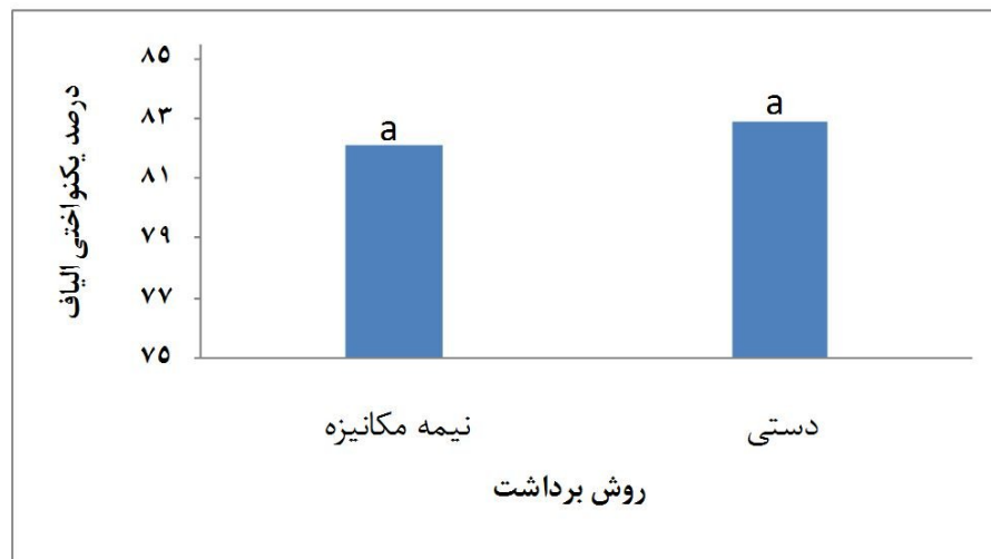
شکل ۶: تغییرات یکنواختی الیاف پنبه در دو روش برداشت دستی و دستگاه نیمه‌مکانیزه
