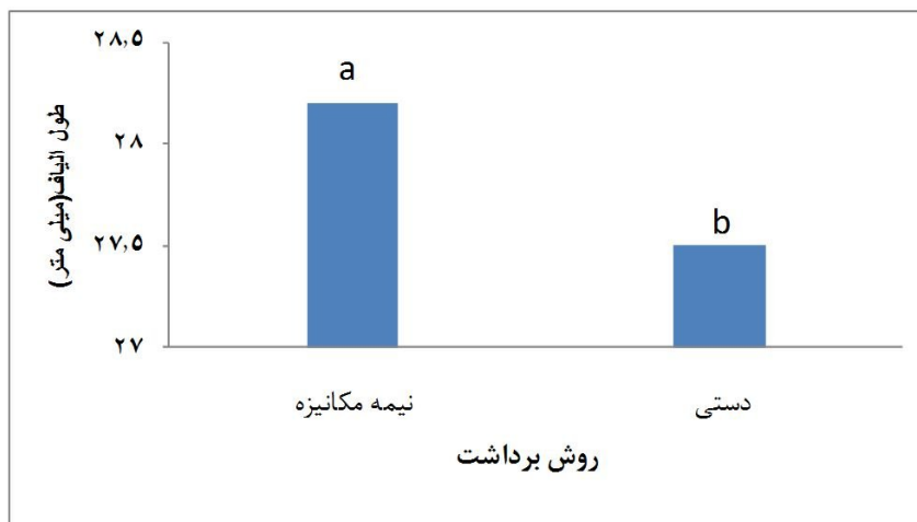
شکل ۵: تغییرات طول الیاف در دو روش برداشت پنبه دستی و دستگاه نیمه مکانیزه
