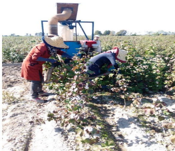
شکل ۲: برداشت پنبه توسط دستگاه نیمه‌مکانیزه
