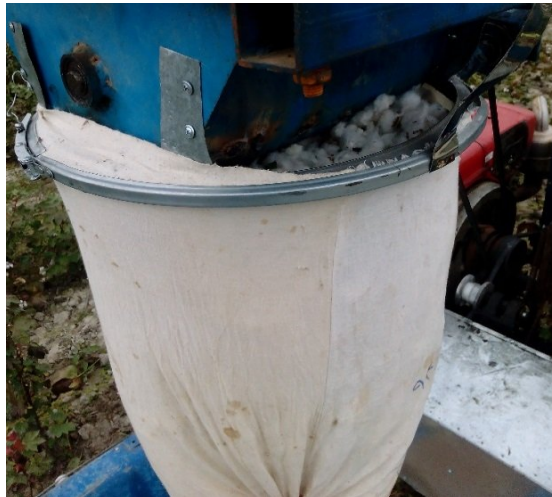
شکل 3: کیسه برداشت وش متصل به دستگاه
